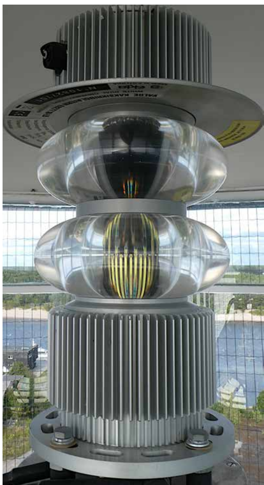
Используемый в настоящее время светодиодный фонарь Sabik E8277.W-LB, фото Т. Вилу
