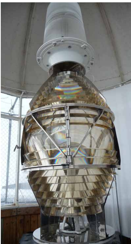
Фонарь ASA-500 и резервный фонарь NL-300 сверху, фото В. Лаитус
