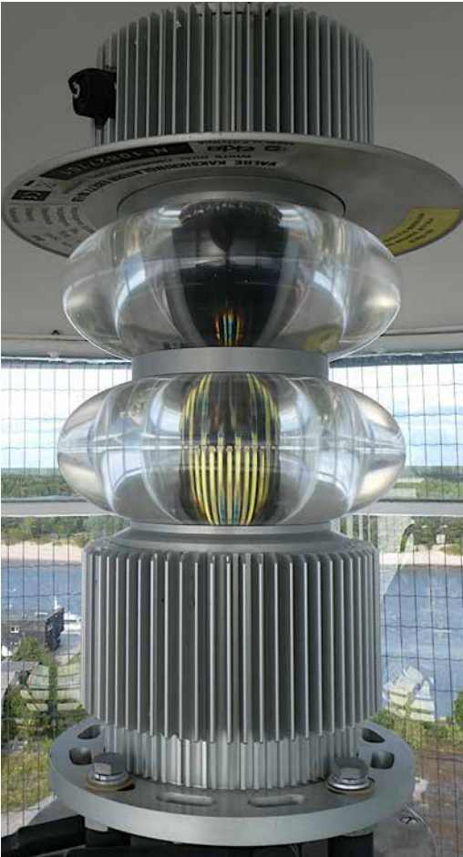
Tänapäeval kasutatav LED-latern Sabik E8277.W-LB, foto T. Vilu
